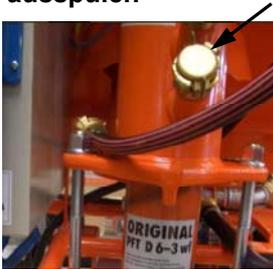
Abb.41: Blinddeckel am Wasserstutzen
