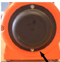
Abb. 60: Öffnung Filterabdeckung
