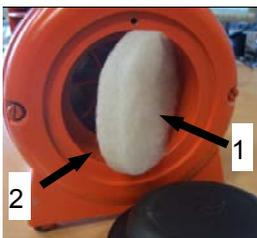
Abb. 59: Filter des Kompressors
