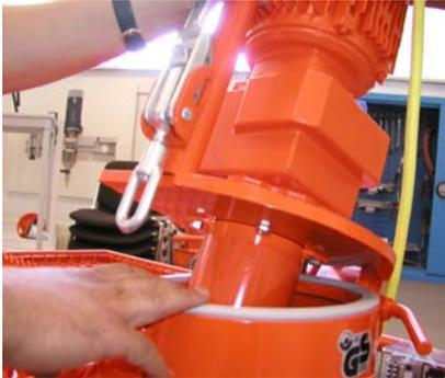
Abb.38: Motorkippflansch schließen
