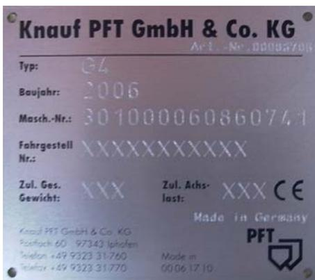
Das Typenschild befindet sich an der Innenseite der Werkzeugkiste und beinhaltet folgende Angaben:
