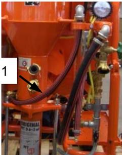
Abb.46: Wasserzufuhr trennen
