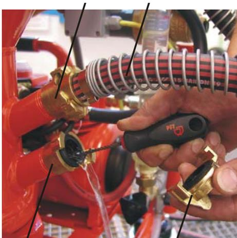
Abb. 19: Blinddeckel und Wasserstutzen
