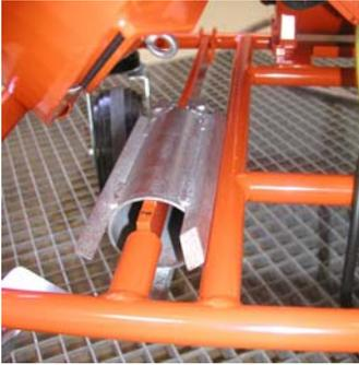
Abb.37: Mischrohrreiniger einsetzen
