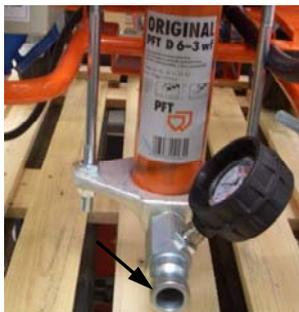
Abb.43: Ablagerung Druckflansch
